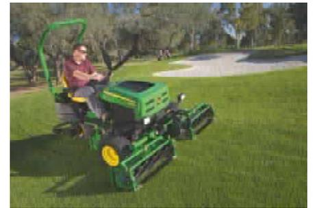
**Spindelmäher** von 1,8 m bis 3,50m
