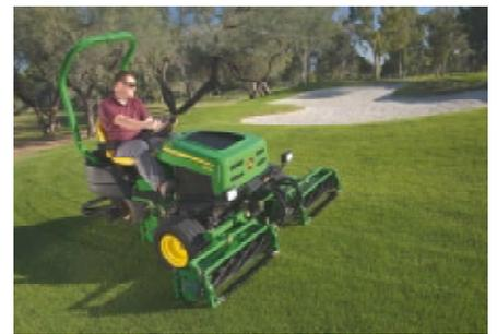
**Spindelmäher** von 1,8 m bis 3,50m
